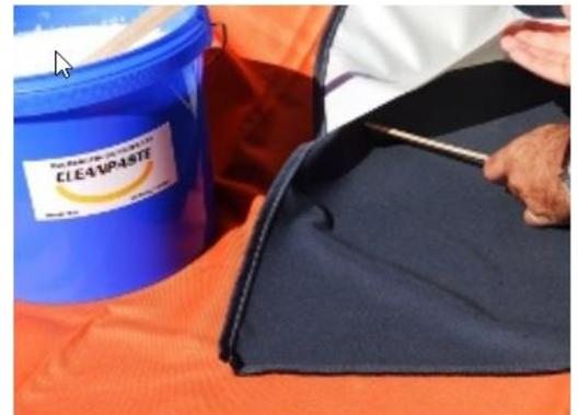
Eine Sonder-Reinigung eventuell verkrusteter Brücken funktioniert wirksam, wenn die Brücken mit CLEANPASTE „eingekremt“ und anschließend mit tropfnassen Lappen abgewischt werden. Diese Behandlung erspart eventuell eine mechanische Reinigung der Brücken mit Schleifmitteln.
