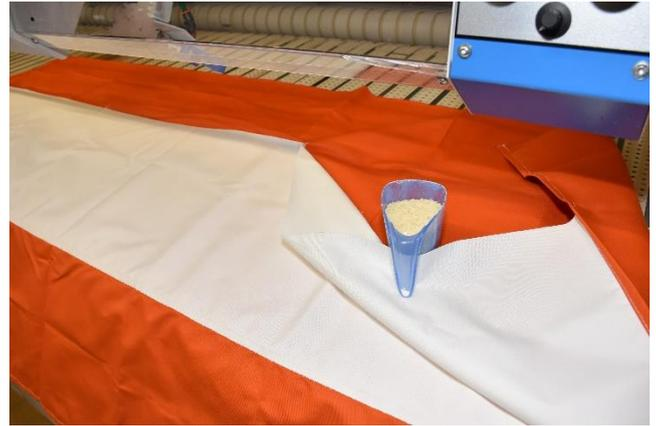
Der Inhalt der Wachstasche ist fast immer ausreichend für einen weiteren Wachsgang ohne erneute Wachszugabe. Bei Mehrschichtbetrieb ist evtl. ein neuerliches Einstreuen von Wachs angeraten.
